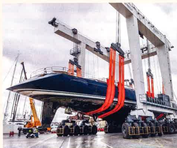
1000-Tonnen-Kran: STP Shipyard in Palma de Mallorca startete den Betrieb des größten Travellifts Europas.
