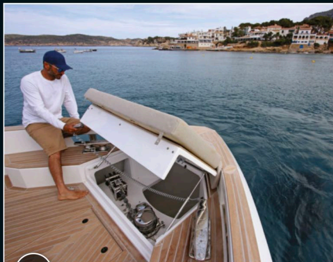
On accède aux appareils de mouillage en soulevant la banquette avant.
