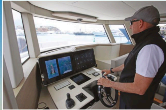
Deux écrans Garmin de 22 pouces permettent de visualiser les images des caméras du bord. Une porte latérale donne un accès direct au passavant.
