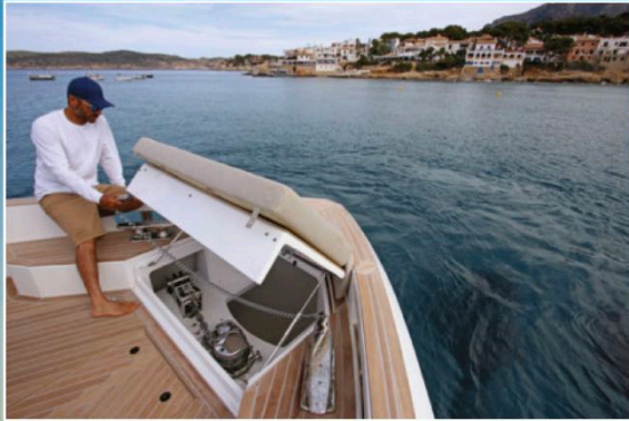
On accède aux appareils de mouillage en soulevant la banquette avant.
