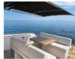
Fahrstand und Pantryeinheit schützt ein T-Top, und achtern im Bereich der Sitz-Liege-Kombination macht ein elektrisch betriebenes Bimini-Dach (Extra) den Job
